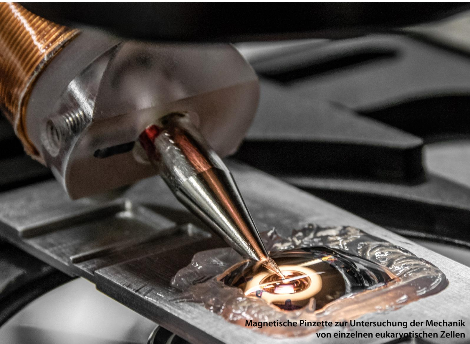
Magnetische Pinzette zur Untersuchung der Mechanik
